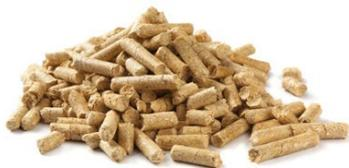
Il **pellet** utilizzato in generatori di potenza termica nominale fino a 35 kW deve essere certificato di classe A1 da un organismo di certificazione accreditato secondo la norma ISO/IEC 17065 sulla base delle analisi delle proprietà del combustibile accreditate secondo le metodologie di prova definite dalla norma UNI EN ISO 17225-2.
