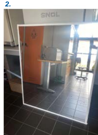
(1) Operazione di lavaggio di un campo solare PTC; (2) Prototipo di superficie riflettente autopulente (C.R. ENEA di Portici)
