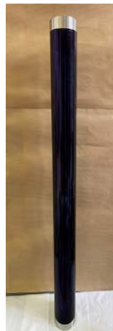
(1) Coating depositato su tubo di acciaio; (2) Impianto di sputtering “ENEА-2”; (3) Processo di deposizione in plasma (C.R. ENEA Portici)
