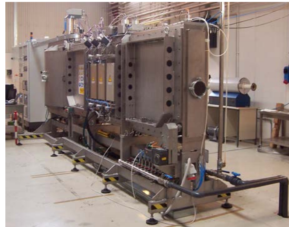
(1) Coating depositato su tubo di acciaio; (2) Impianto di sputtering “ENEА-2”; (3) Processo di deposizione in plasma (C.R. ENEA Portici)
