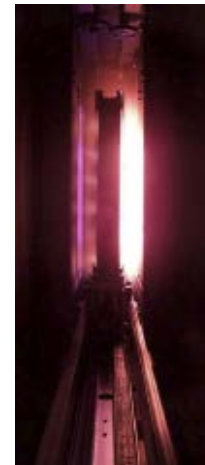
(1) Coating depositato su tubo di acciaio; (2) Impianto di sputtering “ENEА-2”; (3) Processo di deposizione in plasma (C.R. ENEA Portici)
