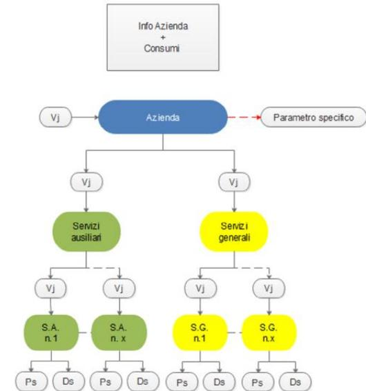
*Schematizzazione della struttura energetica aziendale nel terziario (GDO, Banche, Immobiliare etc) fonte ENEA Linee guida Diagnosi Energetiche*
